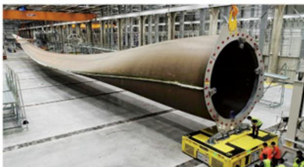
LM 风电集团 107 米风电叶片已在法国瑟堡 (Cherbourg) 工厂完成叶片成型。该叶片后续将进行表面处理，然后再进行严格的测试，验证其是否能在海上运行 20 年。
